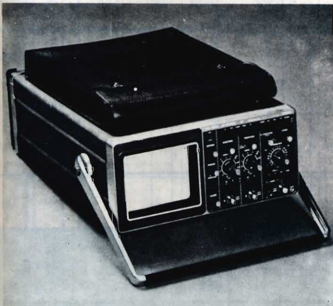
Un trigger accoppiato in c.c. caratterizza il modello Philips 3212. L'oscilloscopio ha in opzione la batteria; un apparecchio simile è il modello 3214 con base dei tempi ritardata.
