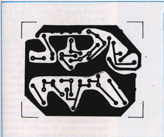
Fig. 3 - Basetta stampata su cui è allestito lo stadio preamplificatore.
