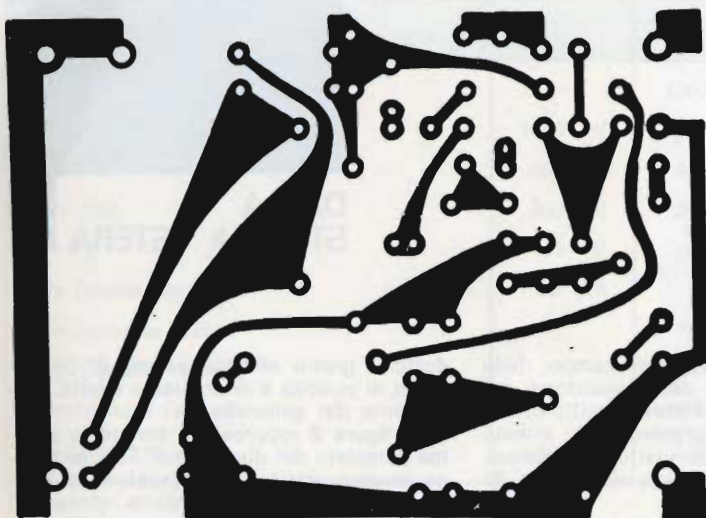
Fig. 3-A - Lato rame del circuito stampato per la realizzazione dello stroboscopio.
